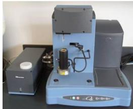
تقوم أجهزة التحليل الوزني الحرارى بفحص عينات الأدوية والمركبات العضوية والغير العضوية لمعرفة ثباتها الحرارى (درجة الحرارة من  $200^{\circ}\text{C}$  إلى  $1000^{\circ}\text{C}$  لعينات وزنها حتى 1 جرام).
